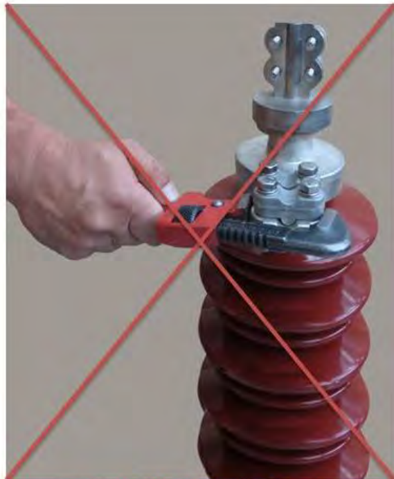
تحت هیچ شرایطی جهت کلمپ ها را تغییر ندهید (چرخش کلمپ ها باعث قطعی در اتصالات داخلی میگردد).
